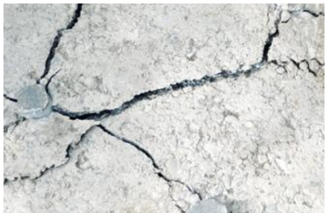
Abb. 9 Spalten durch Quelldruck
